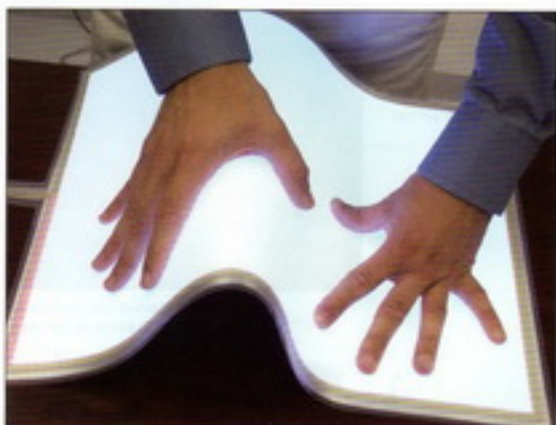
La sostanza luminescente utilizzata nei pannelli LEC è costituita da fosfori microincapsulati prodotti da Osram Sylvania
